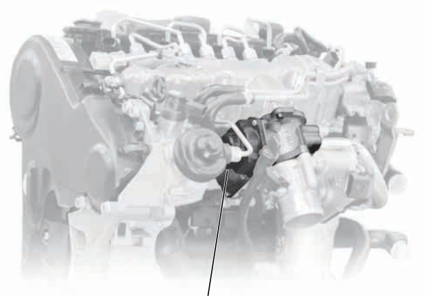
Soupape de recyclage N18 et transmetteur d'angle de la soupape de recyclage des gaz d'échappement G212
