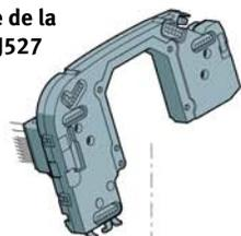
Commutateur d'essuie-glaces E avec régulateur de la connexion à intervalles de l'essuie-glaces E38
