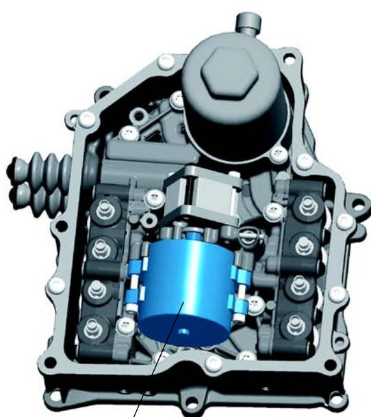
Motor de la pompe hydraulique V401
