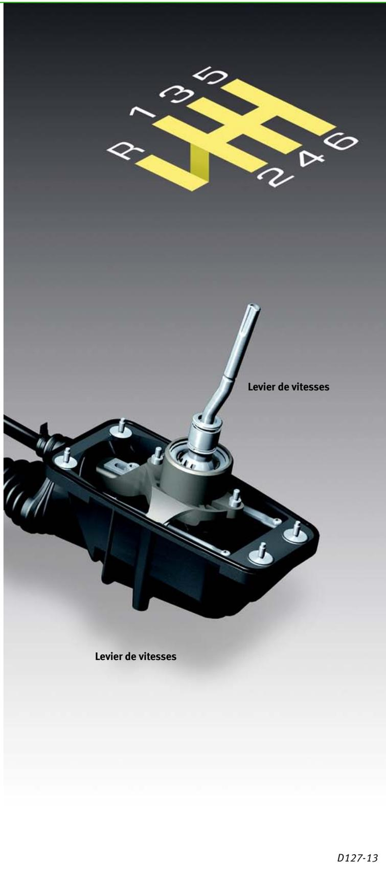
Les mouvements effectués par le conducteur sur le levier de vitesses sont transmis à l'intérieur de la BV par les éléments de commande sous forme de deux mouvements : le mouvement de sélection et celui d'engagement.
