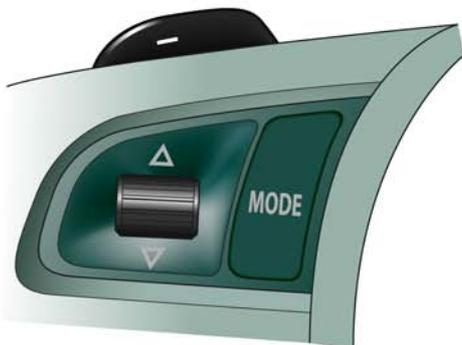
Commande de Tiptronic au volant, passer une vitesse supérieure E438
