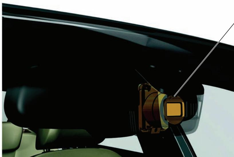
Rétroiseur intérieur avec appareil de commande de l'assistant de feux de route J844 et caméra
