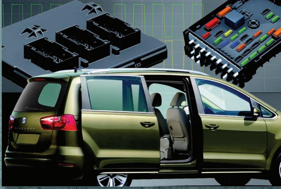
Alhambra offre un système électrique **décentralisé**, suivant la ligne déjà employée sur d'autres modèles SEAT, et dispose de plusieurs lignes de bus CAN et bus LIN ; il intègre de nouveaux équipements qui améliorent le **confort** de l'utilisateur et la **sécurité** pendant la circulation.
