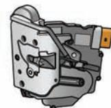
Commande de fermeture centralisée portière arrière gauche F222
