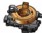
Appareil de commande des capteurs du levier de vitesses J587
