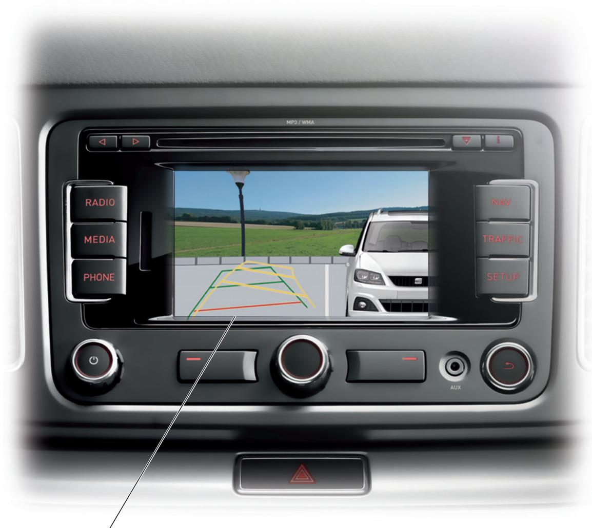
Appareil de commande avec écran pour autoradio et système de navigation J503
