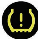
K220 Témoin de l'indicateur de contrôle de la pression des pneus K220
