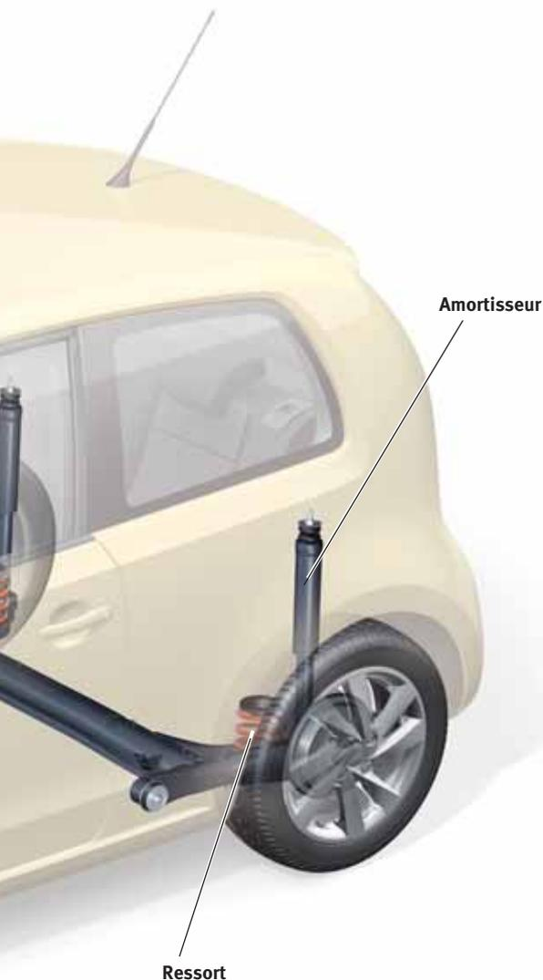
Les trains roulants SEAT Mii sont composés d'un essieu avant de type **McPherson** et d'un essieu arrière de type **essieu rigide à torsion**.
