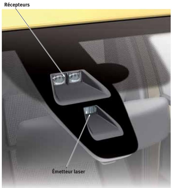
**Appareil de capteurs pour la fonction de freinage d'urgence J939**
