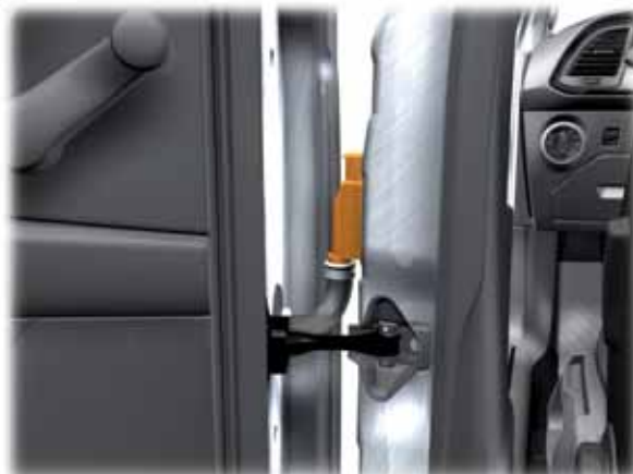
Stations de couplage des portes arrière
