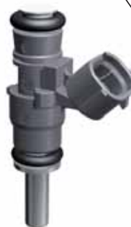
Injecteurs 2 des cylindres 1, 2, 3 et 4 N532 - N535
