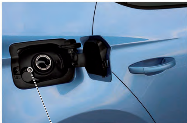
Goulot de remplissage de GNC
