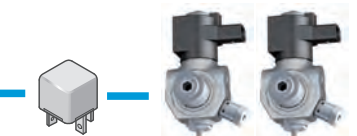
Vanne 1 de fermeture du réservoir N361 Vanne 2 de fermeture du réservoir N362
