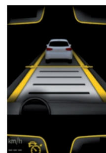
Le système ACC détecte un véhicule à grande distance.
