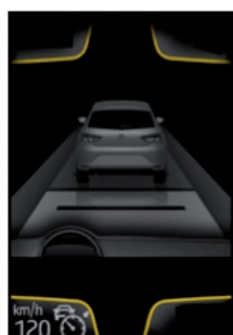
Le système ACC détecte un véhicule mais n'est pas activé.
