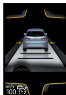
Le système ACC détecte un véhicule à faible distance.
