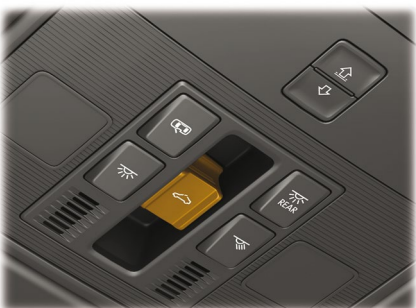
Commande du toit coulissant E8
