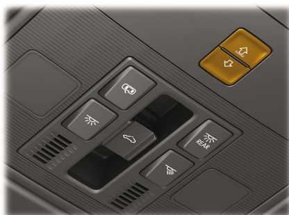
Touche 1 du store du toit E584
