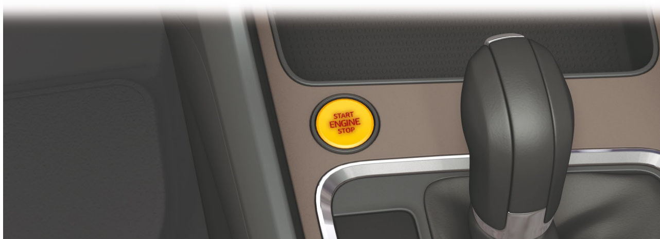
FONCTION HEART BEAT : Séquence signalant au conducteur que le moteur peut être démarré en appuyant sur la touche de dispositif de démarrage E378
