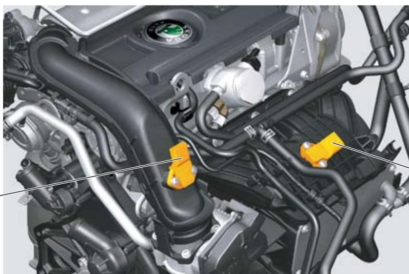
Transmetteur de pression de suralimentation G31 avec transmetteur de température d'air d'admission G299
