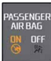
Le témoin de contrôle d'airbag ON/OFF est contrôlé par l'unité de commande d'airbag et l'unité de bord BCM.
