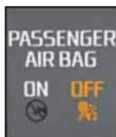
Après l'activation de l'airbag frontal du siège passager avant grâce au contacteur, le témoin de contrôle d'airbag jaune **ON** s'allume après avoir mis le contact. Le témoin s'éteint 65 s après avoir mis le contact.
