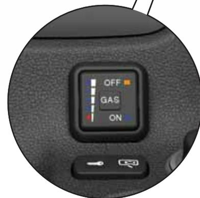
Touche de commutation avec indicateur de réserve de gaz et commande de sélection du carburant
