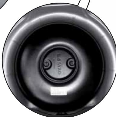
Réservoir de gaz automobile avec soupape multifonctions intégrée
