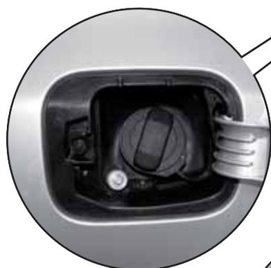
Tubulure de remplissage de gaz
