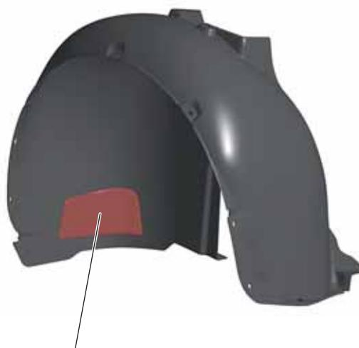
Couvercle de protection du canal d'air sur le modèle Škoda Superb GreenLine II
