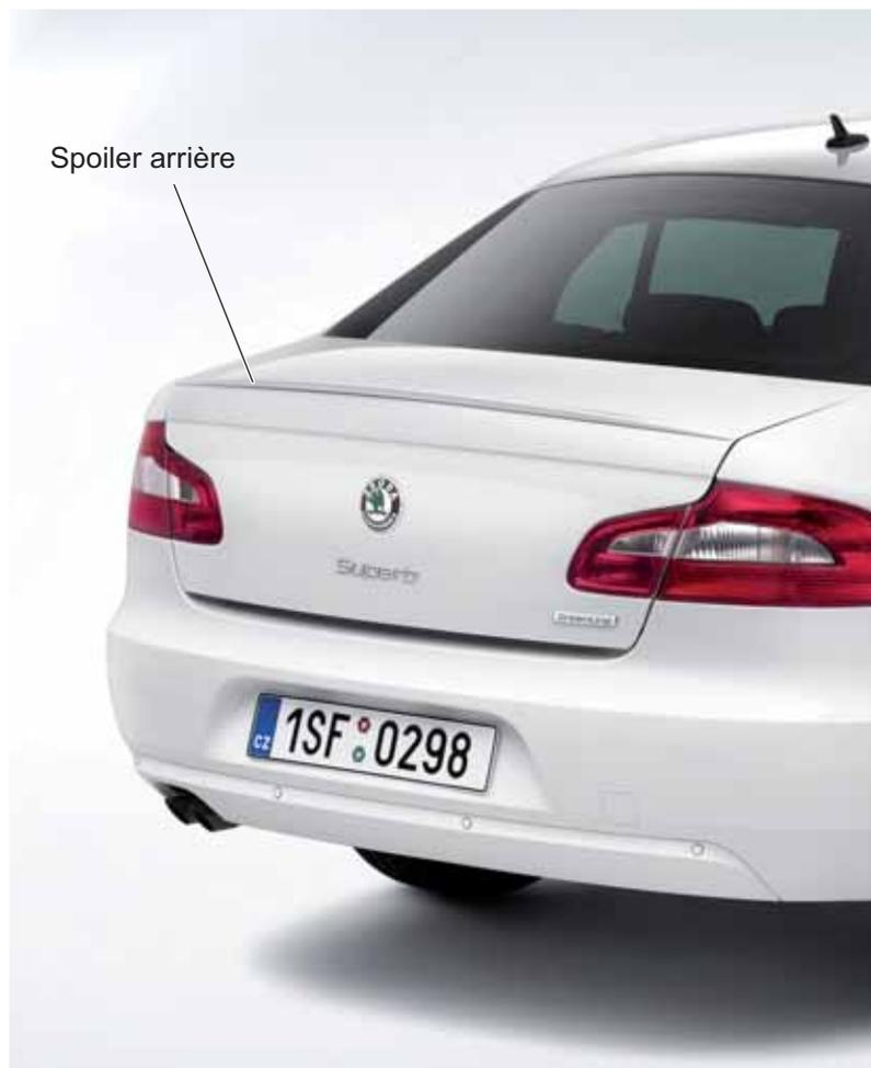
Le coefficient de traînée a été réduit sur le modèle **Škoda Superb/Superb Combi GreenLine II** grâce à:
