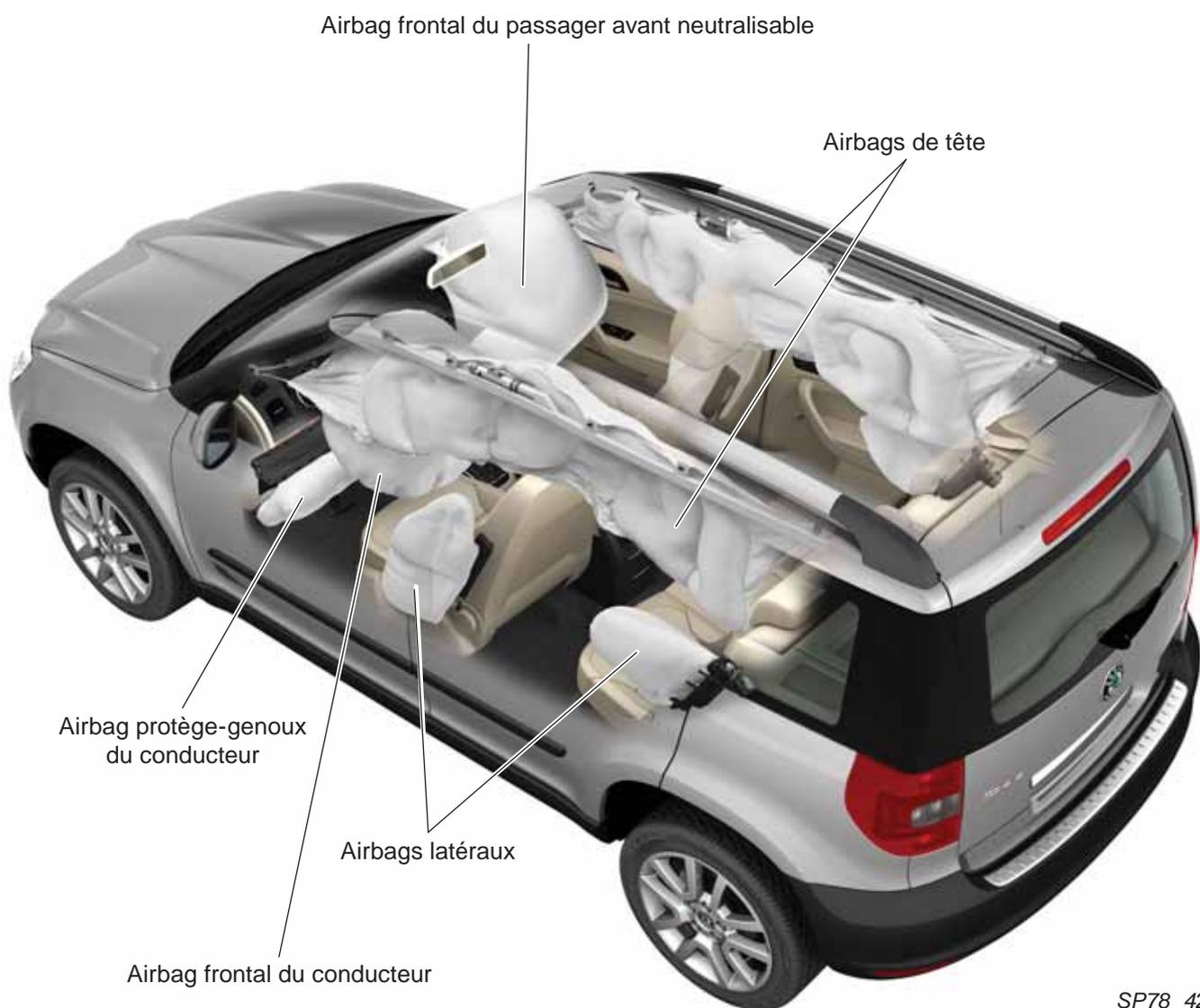
Le calculateur des airbags reçoit les signaux des capteurs d'accélération, des capteurs de pression et du capteur CISS; dans le cas où les informations des capteurs sont analysées comme collision, le calculateur envoie un signal d'activation au groupe concerné des airbags et aux rétracteurs de ceinture. Le système des airbags est donc bien relié aux rétracteurs de ceinture.
