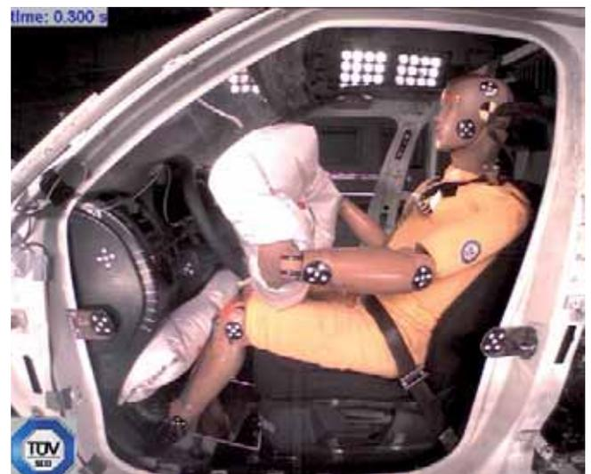
Etat des systèmes de blocage et du mannequin après le test - le volant est poussé de 75 mm vers le moteur.
