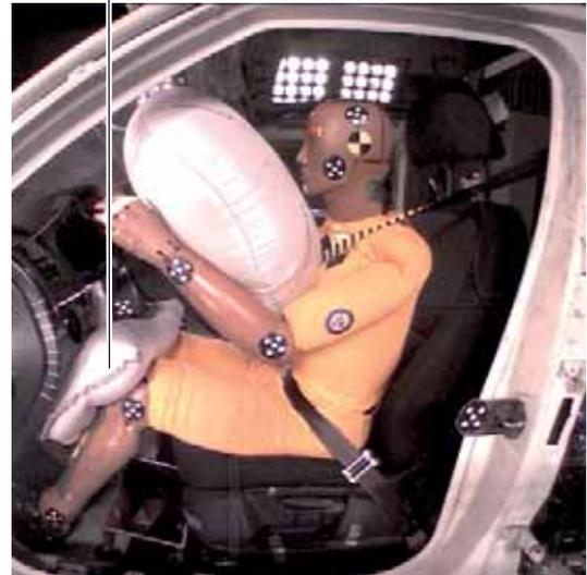
Simulation d'une collision frontale SP78\_78
