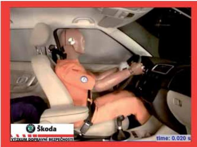
Contact avec un obstacle - Activation du rétracteur de ceinture et de l'airbag. SP78\_28
