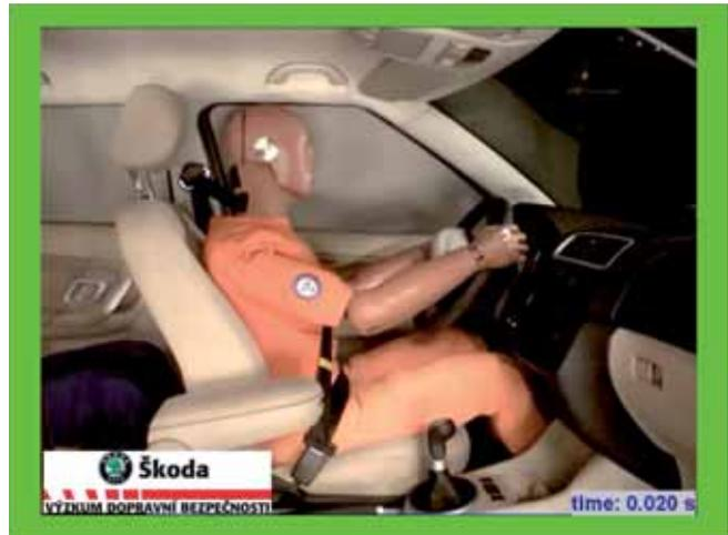
Activation du rétracteur de ceinture et de l'airbag.
