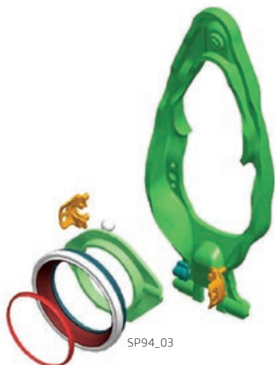
nouvel assemblage du levier sur l'embrayage K1* (à partir du 01.06.2011)
