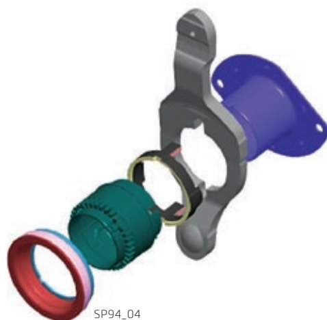
nouvel assemblage du levier sur l'embrayage K2* (à partir du 01.06.2011)
