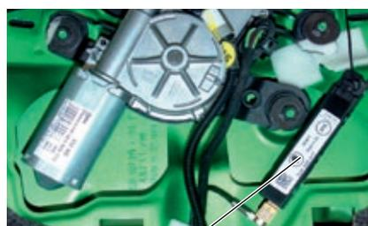
Impédeur R254 via lequel l'antenne est raccordée à l'autoradio
