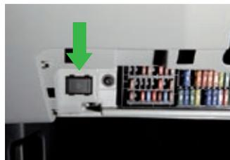
Le commutateur pour l'éclairage diurne est en position 0. Pour activer/désactiver le mode Eclairage diurne, on utilise le commutateur sous le cache du coffret de fusibles dans le tableau de bord. Ce contacteur n'existe pas sur les modèles ŠKODA Rapid, qui sont équipés du système START-STOP (voir description de l'activation de l'éclairage diurne avec le système START-STOP à la page suivante de ce cahier).
