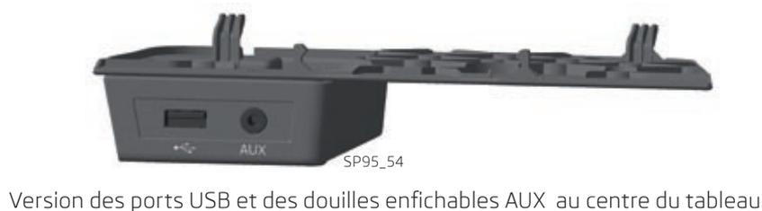
La fiche d'entrée, l'USB avec un signal numérique et la douille enfichable analogique AUX-IN se trouvent dans le véhicule au centre du tableau sous la commande du climatiseur.
