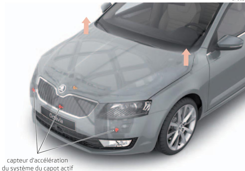
L'image SP96\_11 montre le capot du moteur après son activation. Les flèches indiquent les emplacements des charnières où les actionneurs ont levé le capot. Attention, le capteur indiqué en jaune, qui se trouve sur la partie frontale du véhicule, ne fait pas partie du système du capot actif, mais du système des airbags (voir document SSP97).
