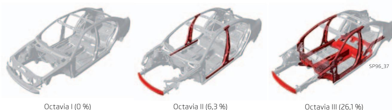
L'image montre sur trois modèles d'Octavia l'évolution de l'utilisation de formage des tôles en acier à chaud.
