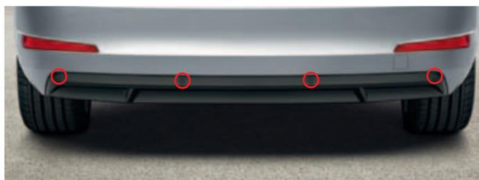
Emplacement des capteurs PDC dans le diffuseur qui fait partie du pare-chocs arrière
