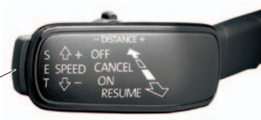
**Speed:** Permet de régler la vitesse dans la plage de 30 à 160 km/h.
