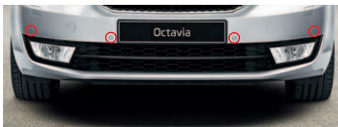
Emplacement des capteurs PDC dans le pare-chocs avant
