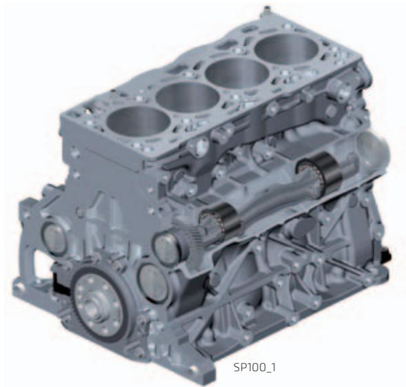
bloc de moteur 2,0 l 135 kW avec emplacement des arbres d'équilibrage
