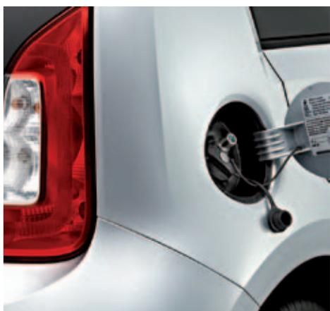
Le positionnement du col de remplissage du gaz naturel sur le véhicule ŠKODA Citigo.
