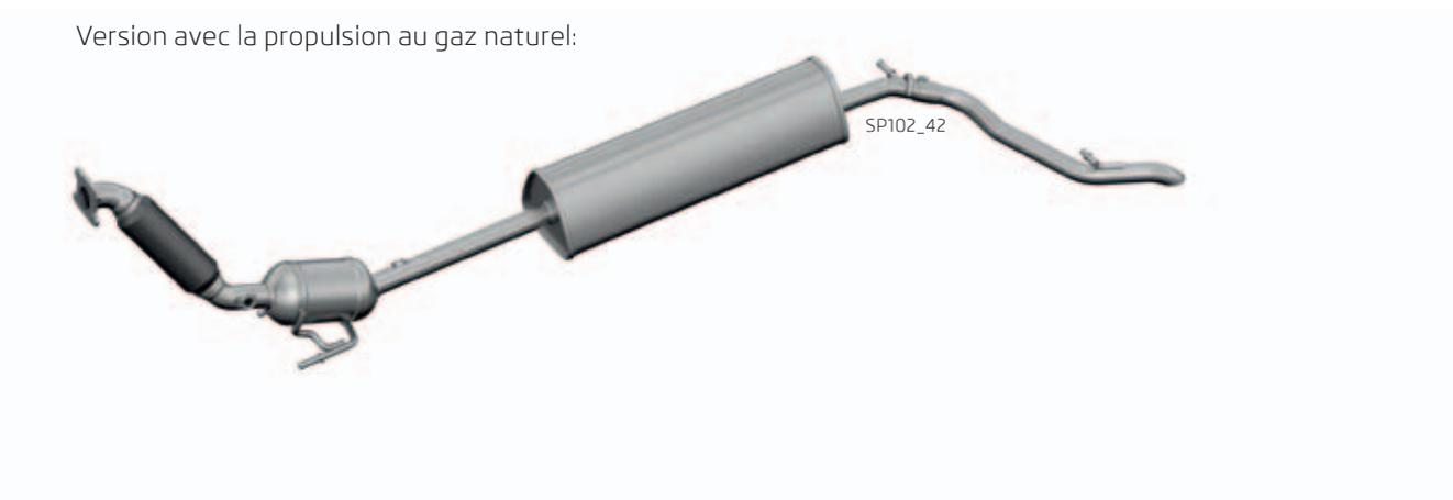
La tuyauterie d'échappement du modèle ŠKODA Citigo GNV avec une propulsion au gaz est raccourcie et terminée à côté gauche sous la partie inférieure de carrosserie au compartiment avant l'essieu arrière (à cause de placement des réservoirs de carburant à GNV) au compartiment derrière et avant l'essieu arrière.
