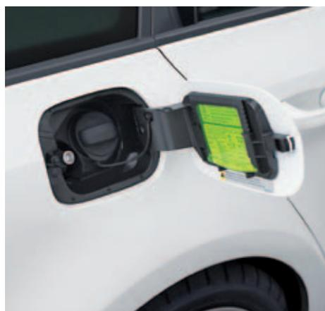
Le positionnement du col de remplissage du gaz naturel sur le véhicule ŠKODA Octavia G-TEC.
