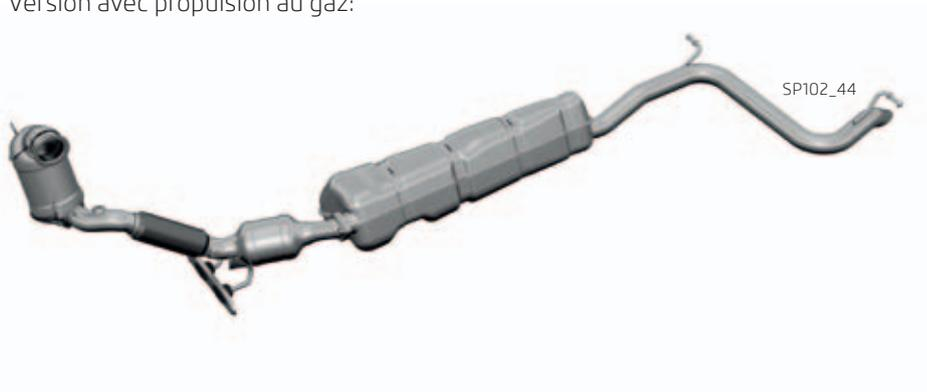
La tuyauterie d'échappement du modèle ŠKODA Octavia G-TEC avec une propulsion au gaz naturel est raccourcie et terminée à côté gauche sous la partie inférieure de la carrosserie au compartiment avant l'essieu arrière (à cause de placement des réservoirs de carburant à GNV) au compartiment derrière l'essieu arrière. C'est pourquoi le silencieux arrière a dû être supprimé. Pour la version du véhicule au gaz naturel, un amortisseur avant spécialement a été spécialement élargi.
