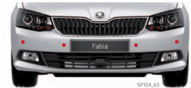
Emplacement des capteurs PDC dans le pare-chocs avant
