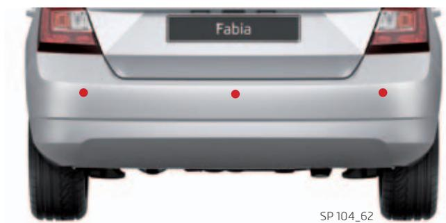
Emplacement des capteurs PDC dans le pare-chocs arrière
