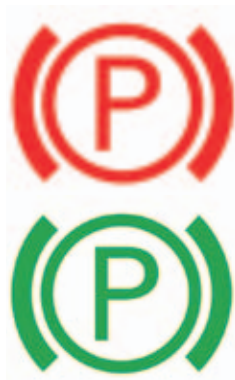
symbole du voyant sur le combiné vert – fonction Auto Hold rouge – frein de stationnement électromécanique
