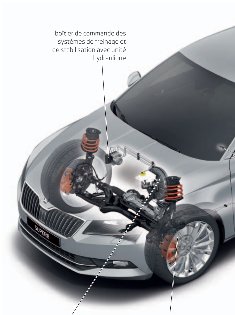
amplificateur de freinage actif avec maître-cylindre
