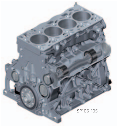
bloc moteur 2,0 l TDI avec positionnement des arbres d'équilibrage et un diamètre de l'alésage des cylindres de 81 mm
