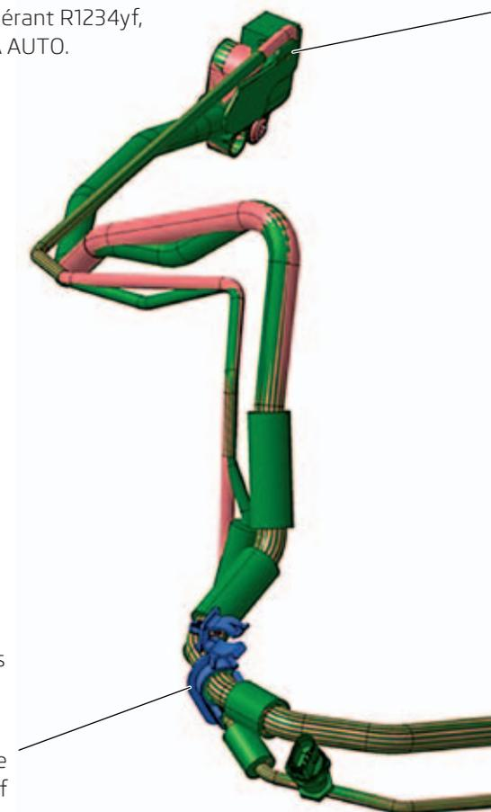
élément identique de fixation au supports des carrosseries R134a et R1234yf
