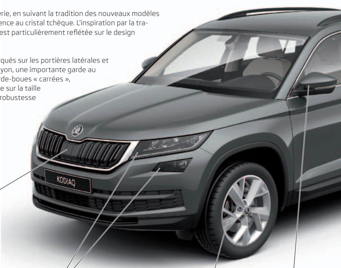
calandre design protégeant également le capteur radar
