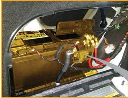
Batterie 12 V dans le coffre à bagages avec boîte de fusibles principaux
