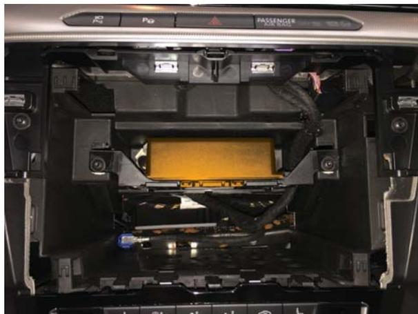
Le calculateur pour module d'appel d'urgence et unité de communication J949 est une interface de transmission de données avec module UMTS intégré. Il transmet et reçoit des données et des ordres pour les services Car-Net Security & Service.
