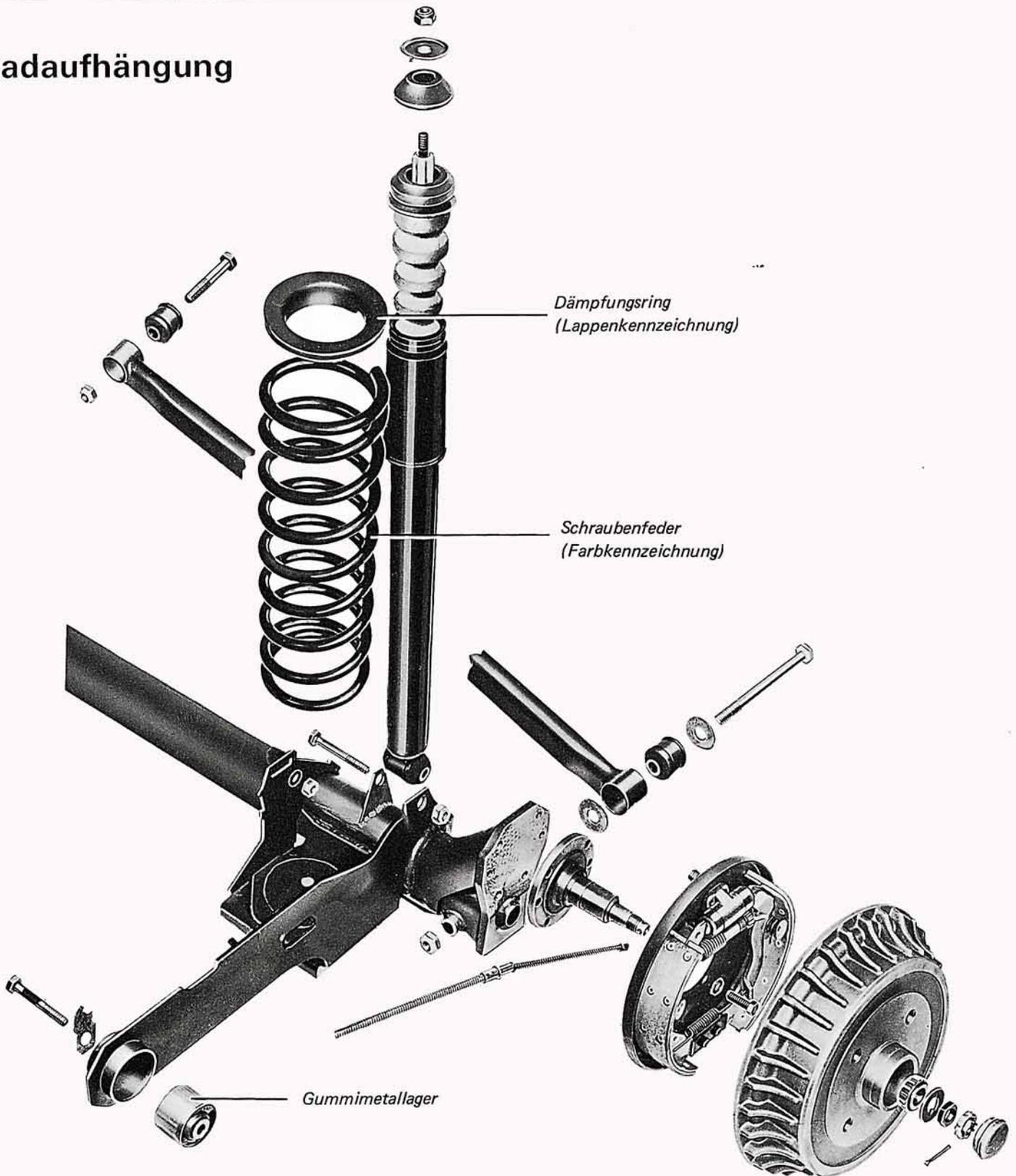
Beim Ersetzen der Schraubenfeder ist die Farbkennzeichnung und beim Dämpfungsring die Lappenkennzeichnung zu beachten
