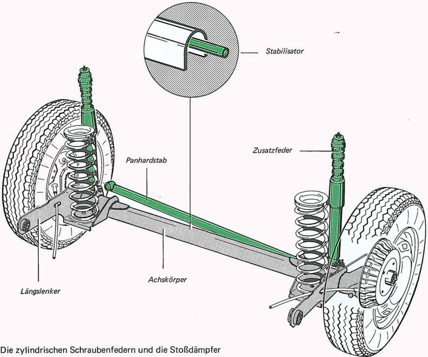
Die zylindrischen Schraubenfedern und die Stoßdämpfer sind getrennt angeordnet.
