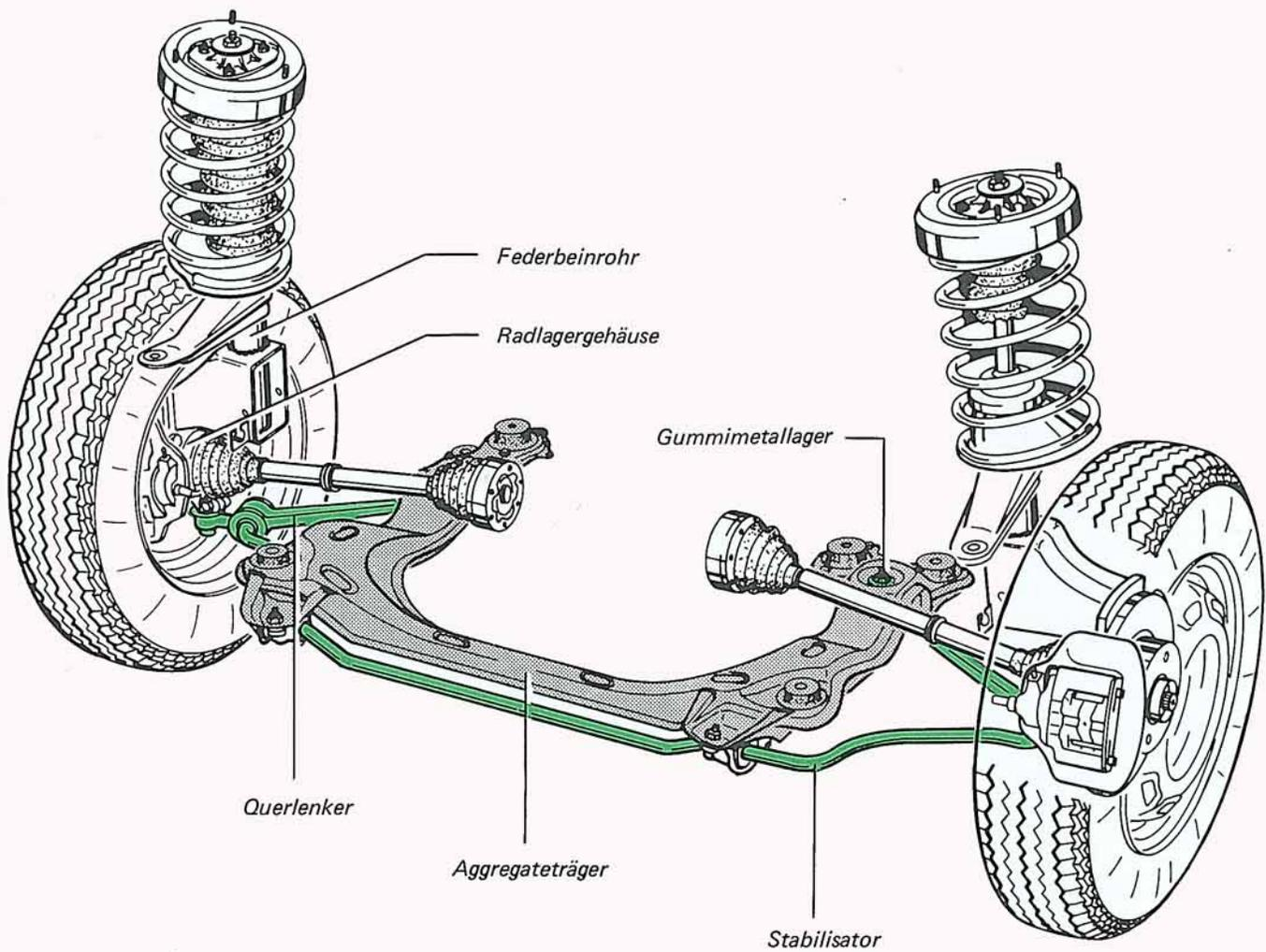
Der Querlenker ist mit einem Gummimetallager am Aggregateträger befestigt. Querlenker und Stabilisator bilden zusammen einen Dreieckslenker, der das Federbein unten führt. Radlagergehäuse und Federbeinrohr sind als Schweißkonstruktion ausgeführt.
