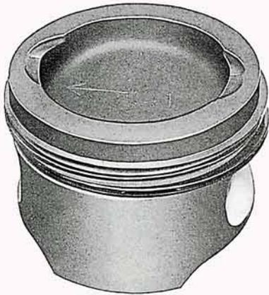
Der Kolben ist am Kolbenboden so verändert, daß der Brennraum zum Teil im Kolbenboden liegt. Durch die Ringfläche wird das Frischgas am Ende des Verdichtungshubes sehr stark gequetscht, damit es gut durchwirbelt. Dadurch wird eine optimale Verbrennung erzielt.
