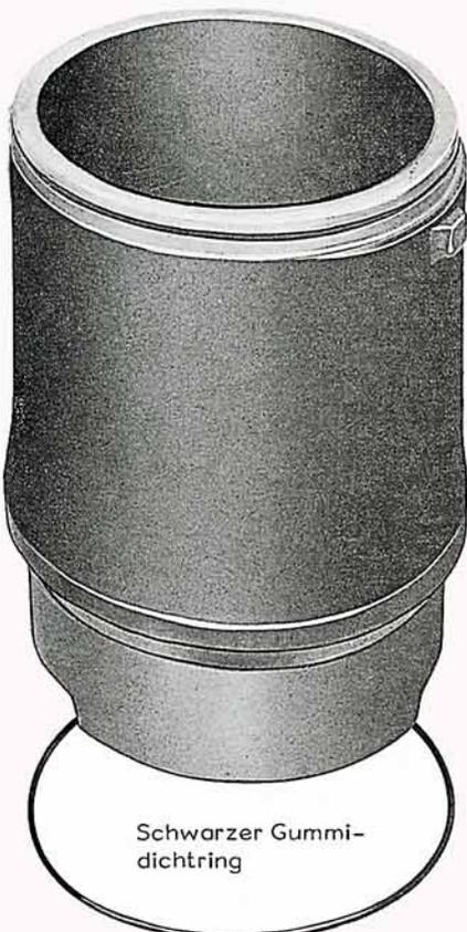
Der Zylinder besteht aus Grauguß. Bedingt durch die Wasserkühlung konnte das Laufspiel zwischen Kolben und Zylinder etwas verringert und dadurch eine noch bessere Laufruhe erzielt werden.
