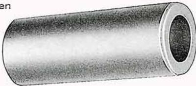
Der Kolbenbolzen ist auf 24 mm  $\varnothing$  verstärkt.
