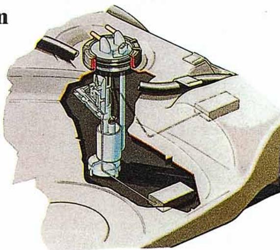
Dieser Geber ist mit einer Kraftstoffvorförderpumpe ausgerüstet. Diese Pumpe fördert den Kraftstoff in den Pumpenspeicher unten am Fahrzeugboden. Kraftstoffüberschuß fließt über die Rücklaufleitung in den Kraftstoffbehälter zurück.
