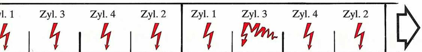
Die gleiche Vorgehensweise gilt für die anderen Zylinder. So kann es durchaus vorkommen, daß je nach klopfendem Betrieb des Motors und damit gegebenenfalls unterschiedlicher Klopfneigung der einzelnen Zylinder während der Zündfolgen sehr unterschiedliche Zündzeitpunkte vorliegen können.
