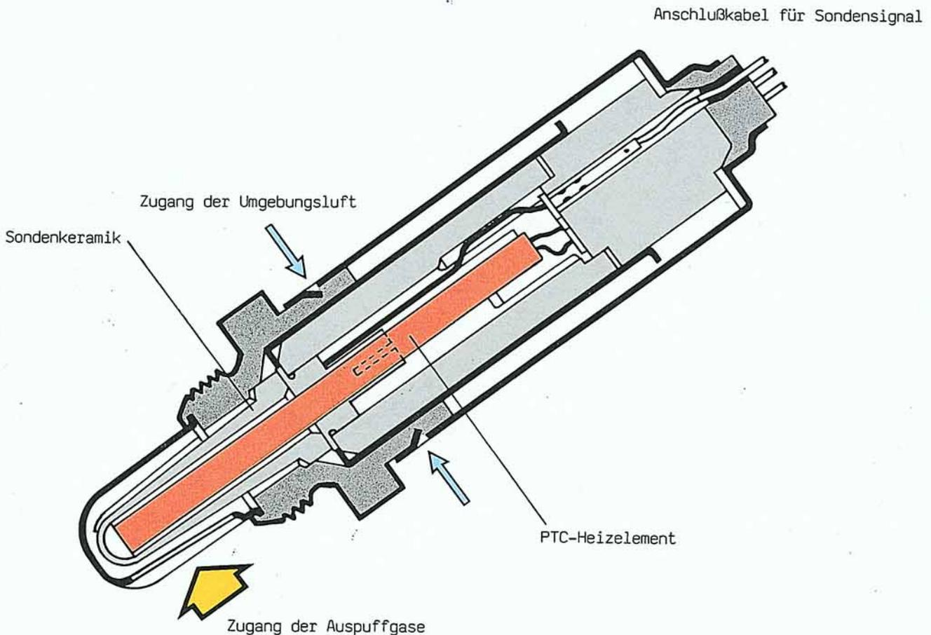
In einem Stahlgehäuse ist ein Keramikeil eingebaut. Die Flächen sind innen und außen mit Platin beschichtet. Bei ca. 300°C wird die Schicht für Sauerstoffionen leitend. Das schnelle Aufheizen besorgt das PTC-Heizelement. Charakteristisch für ein PTC-Heizelement ist, daß zum schnellen Erreichen der Temperatur anfangs die Stromaufnahme groß ist und dann mit steigender Temperatur absinkt.
