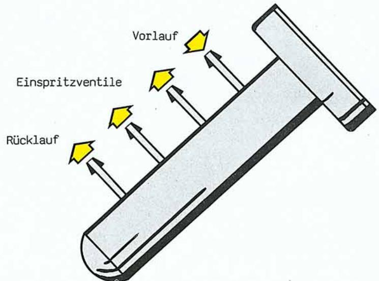
\* Im Vergleich zur K-Jetronic wird nicht ständig, sondern unterbrechend Kraftstoff eingespritzt.
