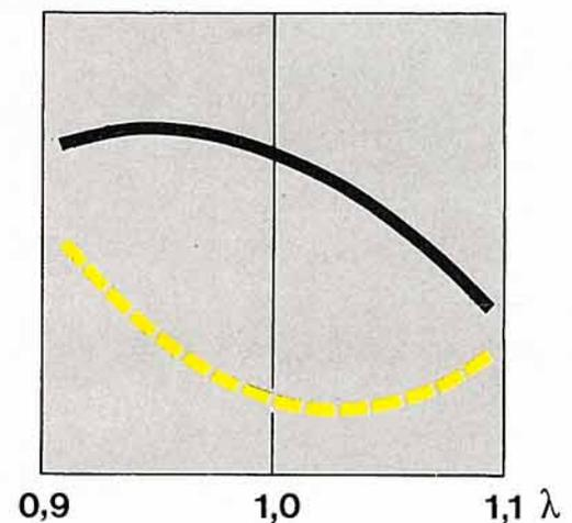
Otto-Motoren erreichen bei  $\lambda$  0,9 bis 0,95 die größte Leistung und bei  $\lambda$  1,0 bis  $\lambda$  1,1 den geringsten Kraftstoffverbrauch. Die Laufgrenzen liegen bei  $\lambda$  0,7 im fetten Bereich und bei  $\lambda$  1,3 im mageren Bereich.
