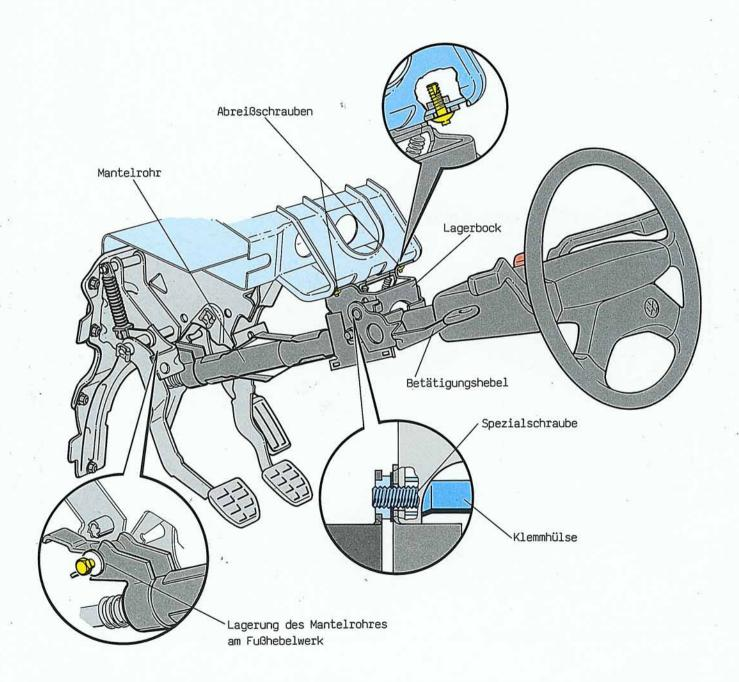
Die Höheneinstellung des Lenkrades erfolgt mechanisch zwischen dem fest über Abreißschrauben an der Karosserie befestigtem Lagerbock und dem Mantelrohr der Lenksäule. Eine Spezialschraube, eine Klemmhülse sowie der Betätigungshebel mit integriertem Gewinde ermöglichen das Lösen bzw. Festsetzen des Mantelrohres zur Höheneinstellung des Lenkrades.
