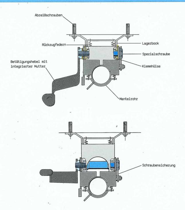
Die Höheneinstellung des Lenkrades erfolgt mechanisch. Nach dem Lösen des Betätigungshebels wird die Klemmwirkung zwischen Lagerbock und Mantelrohr, die in Zusammenwirken durch Klemmhülse und Spezialschraube erzeugt wird, aufgehoben.
