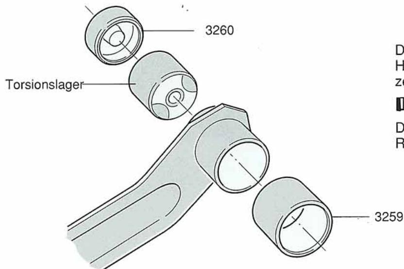
Durch das vergrößerte Torsionslager an der Hinterachse kommen neue Sonderwerkzeuge zum Einsatz.
