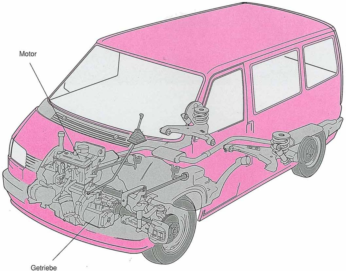
Das Getriebe befindet sich vor der Vorderachse in Fahrtrichtung links, der Motor vor der Vorderachse in Fahrtrichtung rechts.
