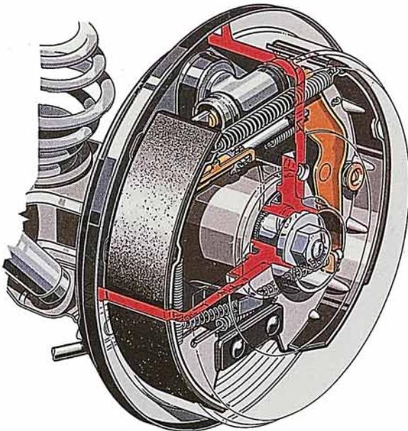
An der Hinterachse wird als Radbremse eine neukonstruierte Simplex-Trommelbremse mit automatischer Bremsbackennachstellung verwendet.
