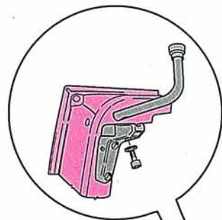
Das Frontend ist abschraubbar. Es erleichtert Montagearbeiten im Motorraum und senkt die Kosten bei Unfallreparaturen.
