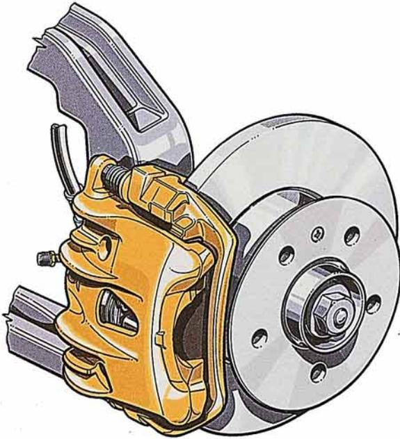
Die Faustsattelbremse für die leichteren Fahrzeuge in Verbindung mit einer 16 mm starken, massiven Bremsscheibe ist aus dem Vorläufermodell bekannt.
