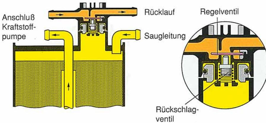
**Vorwärmventil geschlossen - Kraftstofftemperatur über 25 °C**
