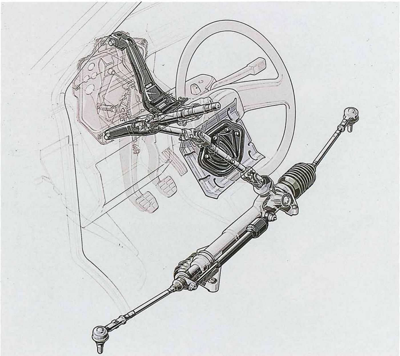
Die Zahnstangenlenkung ist auf dem Aggregateträger befestigt.
