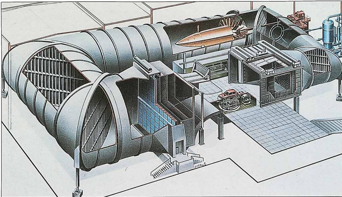
Die geschlossene Luftführung des Windkanals:
