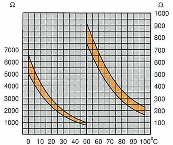
Durch Verarbeitung dieses Gebersignals bestimmt das Digifant-Steuergerät temperaturabhängig die Dauer der Einspritzzeit, die bei betriebswarmem Motor zwischen 2 - 8 ms beträgt. Bei -25 °C Kühlmitteltemperatur wird drehzahlabhängig eine Einspritzzeitverlängerung von max. 70% wirksam, die bis zum Erreichen der Betriebstemperatur auf "Null" abgebaut wird. Weiter wird die Höhe des Steuerstroms für das Leerlaufstabilisierungsventil (Leerlaufdrehzahl) und die Veränderung des Zündzeitpunktes bestimmt.
