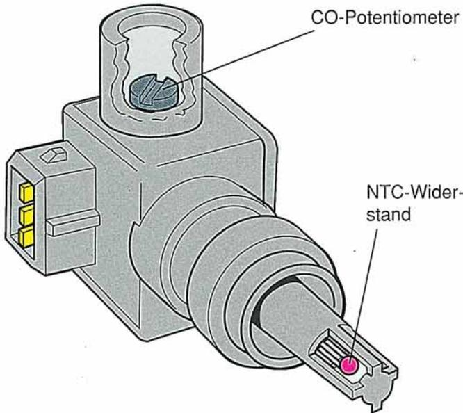
Das CO-Potentiometer erlaubt eine Grundeinstellung des Motors.
