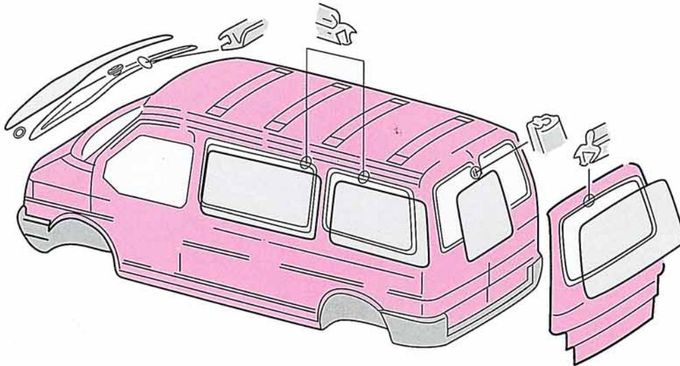
Der neue Transporter wurde erstmals rundum mit einer verklebten Verglasung versehen. Diese gibt der Karosserie wesentlich mehr Steifigkeit. Rohbautoleranzen werden besser ausgeglichen und der Kleber sorgt für eine optimale Dichtigkeit.
