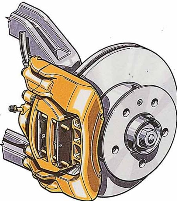
Die Rahmensattelbremse für die schwereren oder schnelleren Fahrzeuge in Verbindung mit einer 24 mm starken, innenbelüfteten Bremsscheibe ist eine Neuentwicklung.
