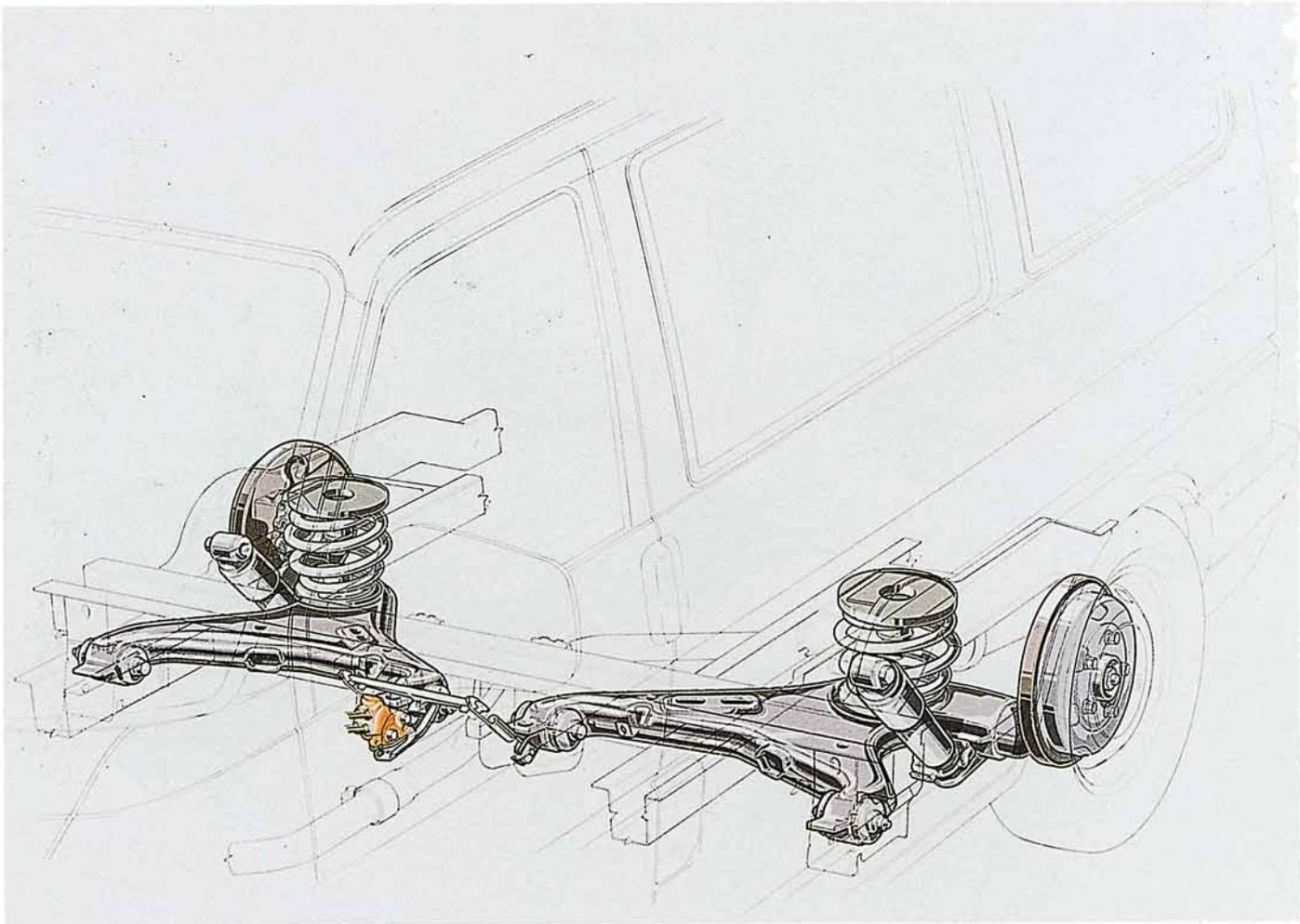
Die Spur wird am inneren Lager des Schräglenkers eingestellt.
