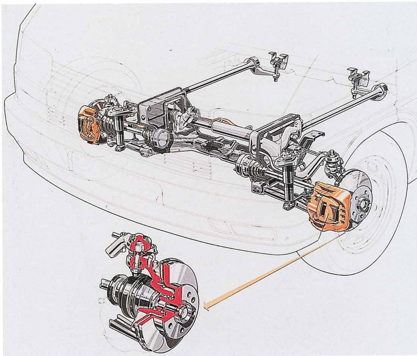
Der Sturz wird am oberen Querlenker durch eine Exzenterbuchse eingestellt.
