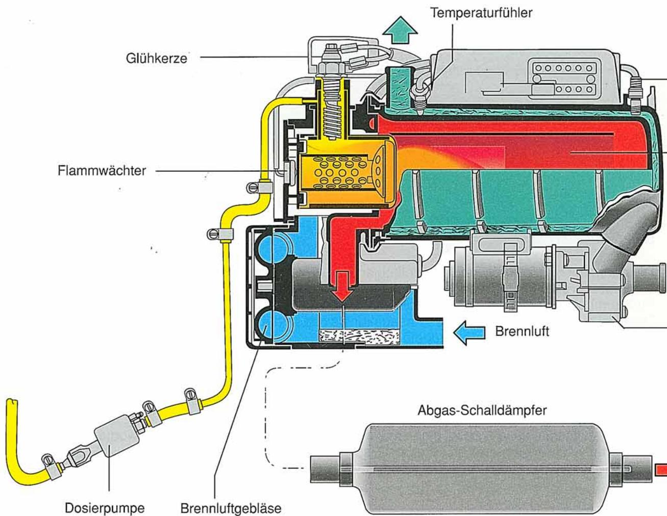
Im Wasserkühlkreislauf des Motors ist eine motorunabhängige Wasserzusatzheizung integriert. Sie erhöht die Heiz- und Kühlwassertemperatur in kürzester Zeit auf über 90 °C und fördert das Kühlwasser über eine Umwälzpumpe zu den Heizungswärmetauschern.
