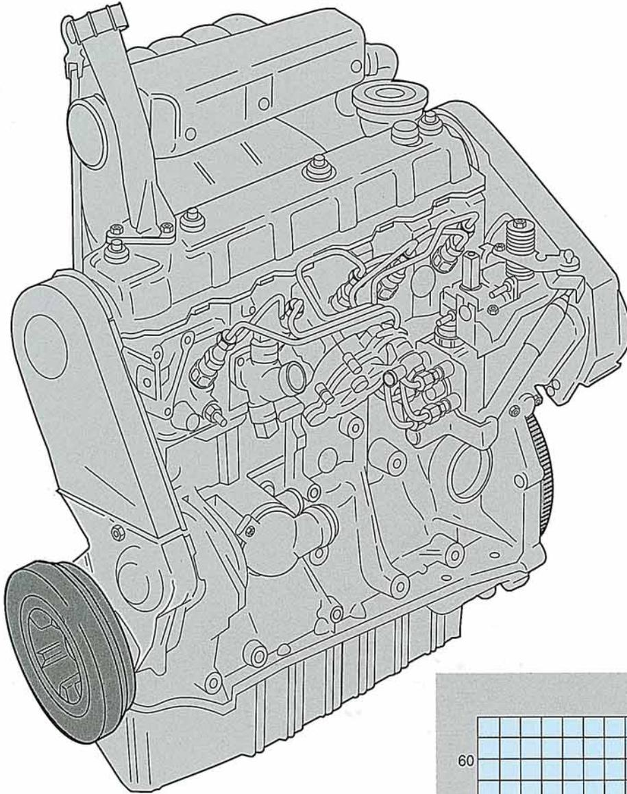
Der 5-Zylinder-Dieselmotor ist ein leistungsstarker Dieselmotor, der nach dem bewährten Wirbelkammer-Prinzip arbeitet und sich durch eine über einen weiten Drehzahlbereich günstig verlaufende Drehmomentkurve auszeichnet. Zudem erfüllt er die gesetzliche Abgas-emissions-Vorschrift ECE 15/04 bzw. 89/491 EWG.
