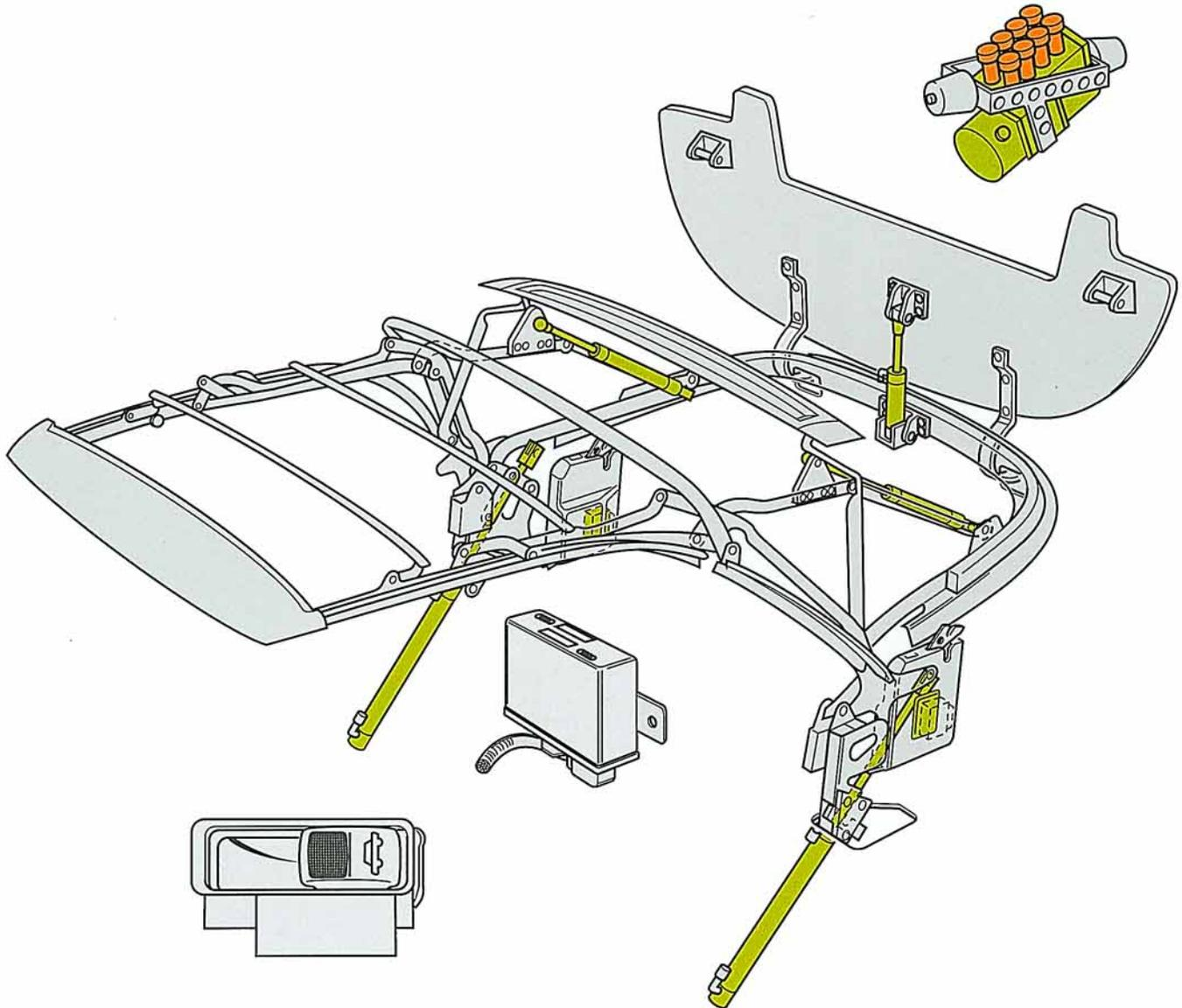
In der Mittelkonsole ist der Schalter für die Verdeckbetätigung untergebracht. Rechts hinter der Rücksitzbank befindet sich das neue Steuergerät.
