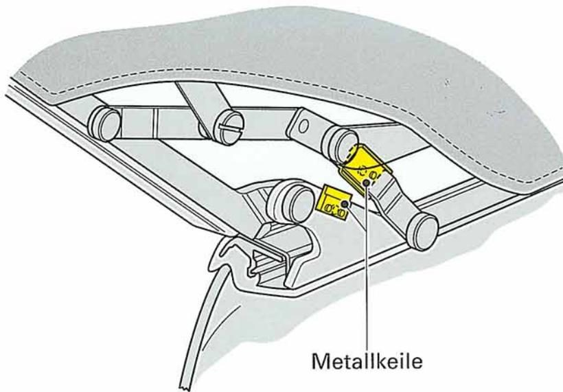
Die Dachrahmenstopper sind am vorderen Verdeckrahmen angebracht. Sie reiben aneinander und verhindern beim Schließen des Verdeckes ein Aufschlagen des Verdeckrahmens auf den Windschutzscheibenrahmen.
