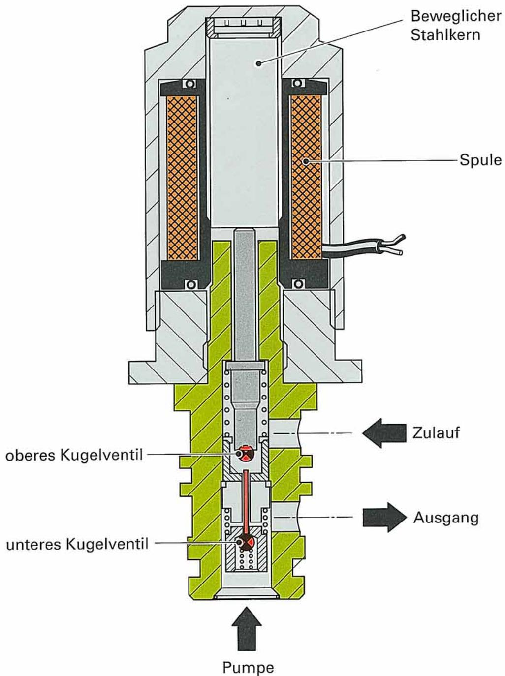
Wenn Strom durch die Spule des Magnetventils fließt, drückt der bewegliche Stahlkern das obere Kugelventil zu.
