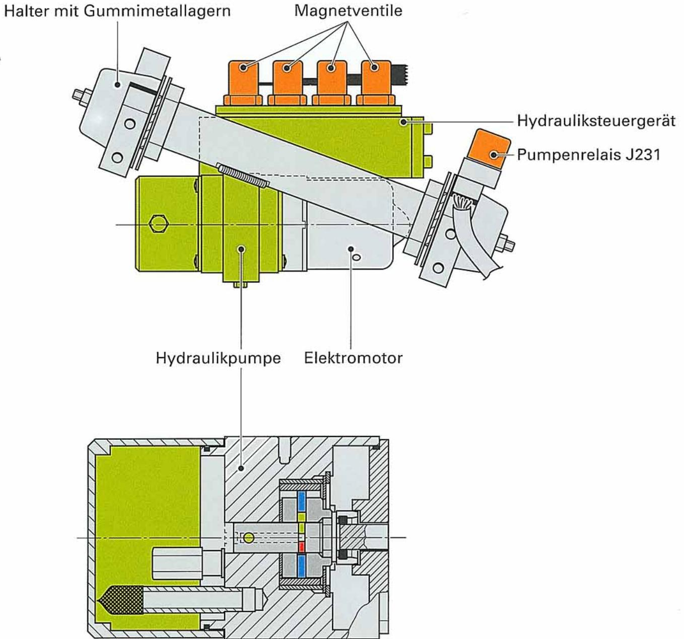
Die gesamte Pumpeneinheit mit Elektromotor, Hydraulikpumpe, Hydrauliksteuergerät, Magnetventilen und Halter mit Gummimetallagern wird als Tilger zum Auffangen von Karosserieschwingungen aus dem Hinterwagen benutzt.
