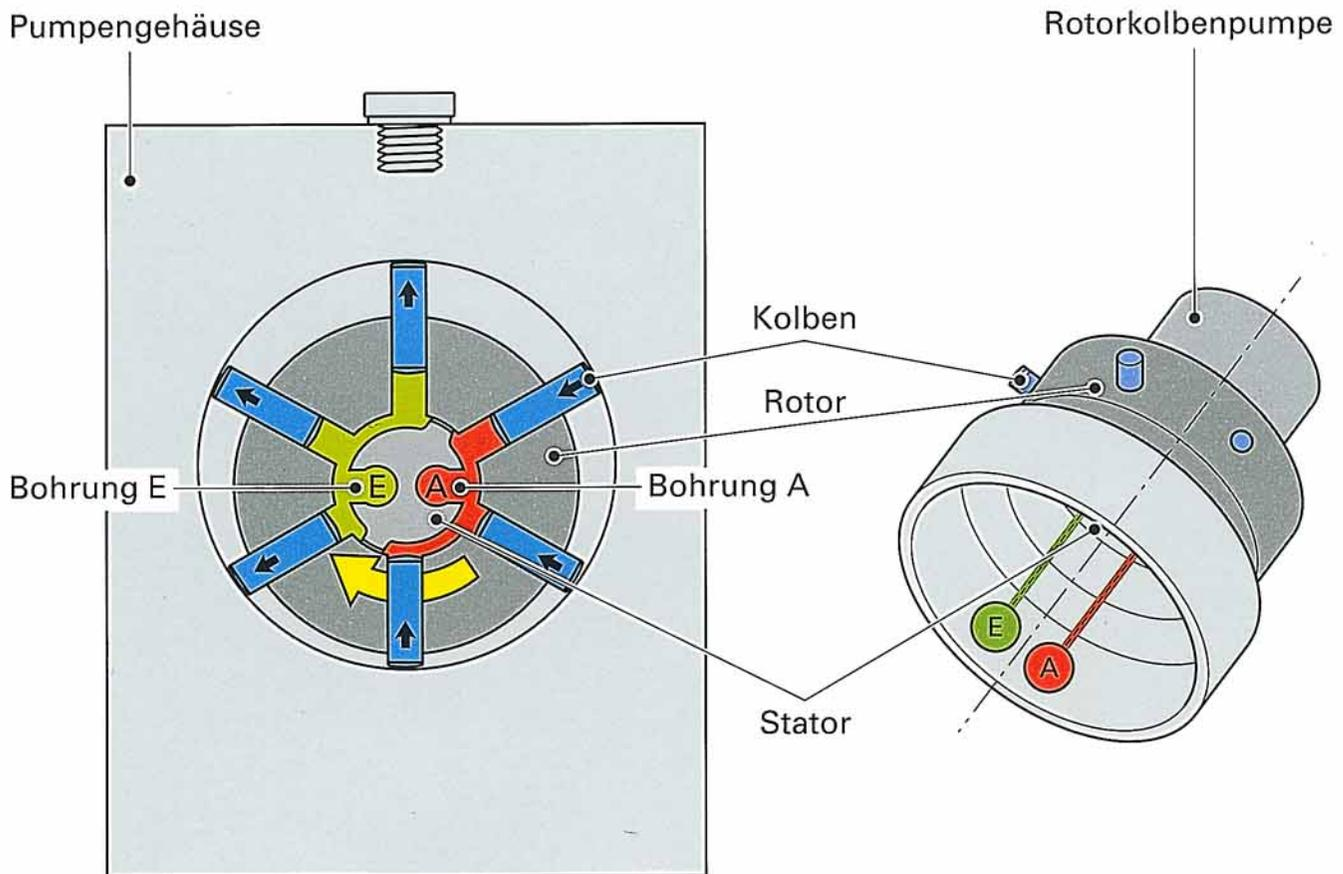
Die Pumpe ist als Rotorkolben ausgelegt. Sie saugt über die Bohrung E Hydraulikflüssigkeit an. Durch die Fliehkraft der Kolben werden die Zylinder gefüllt. Der Rotor dreht sich mit den Kolben um einen außermittig gelagerten Stator. Dadurch werden die Kolben wieder nach innen gedrückt und die Hydraulikflüssigkeit wird mit einem Druck von ca. 100 bar über die Bohrung A in das Hydrauliksteuergerät gefördert.
