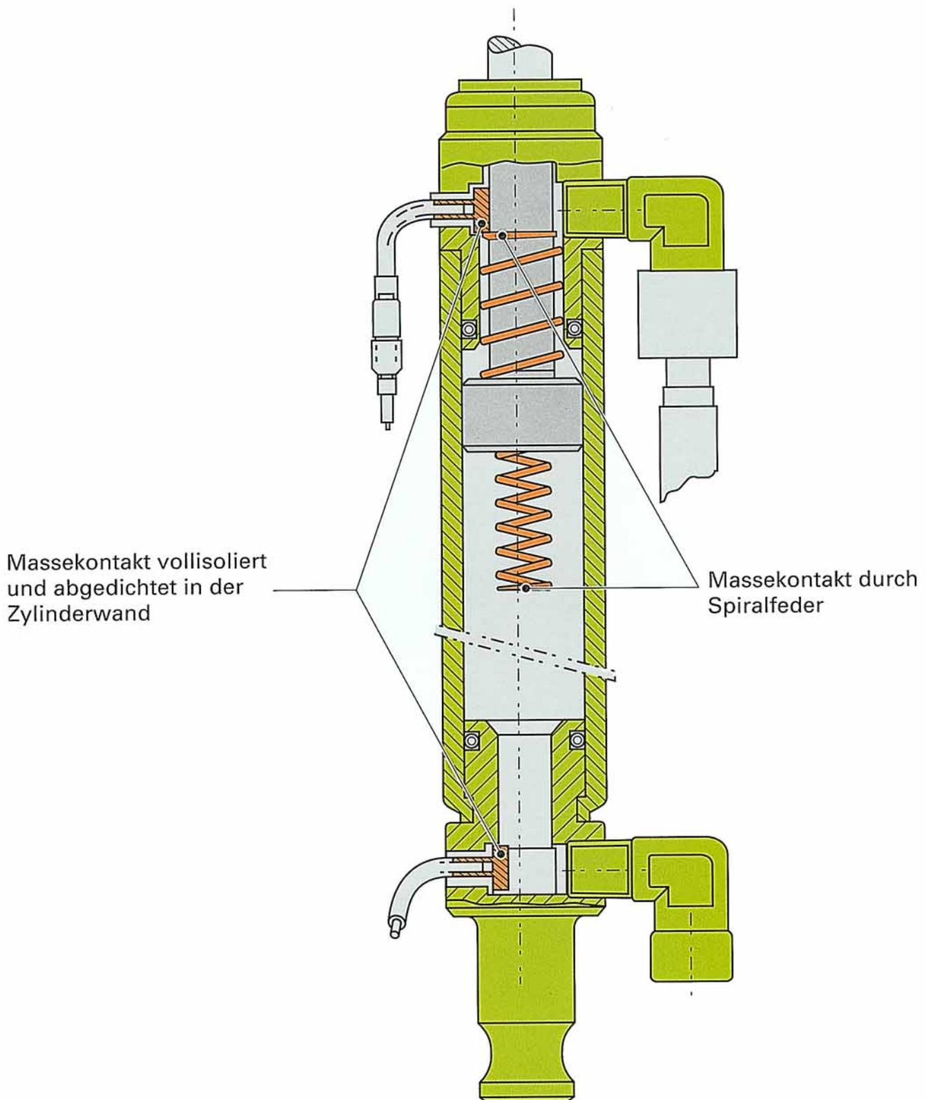
Die Endschalter in den Hydraulikzylindern sind nur auf der rechten Fahrzeugseite verbaut. Sie haben die Aufgabe, dem Steuergerät die Endstellung (Zug- oder Druckposition) mitzuteilen.
