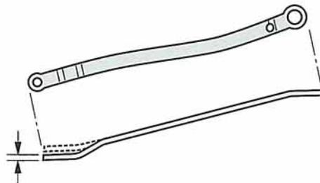
Der Spannhobel hat eine geänderte Kröpfung, damit genügend Platz für den Hydraulikzylinder bleibt.
