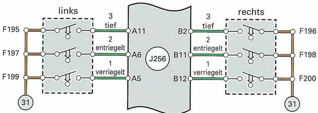
In beiden Verdeckkastendeckelschlössern befinden sich ein Hydraulikzylinder, eine Drehriegelmechanik zum Festhalten des Verdeckkastendeckels und drei Schalter.
