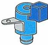
Es wird zur Betätigung der Überbrückungskupplung angesteuert.
