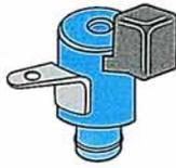
Es steuert die Kupplungs- und Bremsbetätigungszeit. Es ermöglicht komfortables Schalten der Kupplungen und Bremsen.
