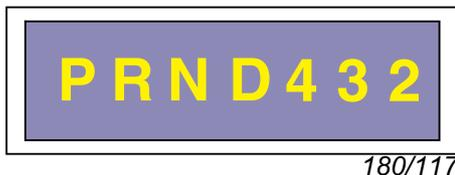
Bei Notlauf und aktivem Steuergerät leuchten alle Segmente der Ganganzeige im Schalttafeleinsatz auf. Die Wählhebelsperre ist aktiv.
