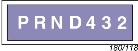
Bei Notlauf und defektem Steuergerät sind alle Segmente der Ganganzeige dunkel.
