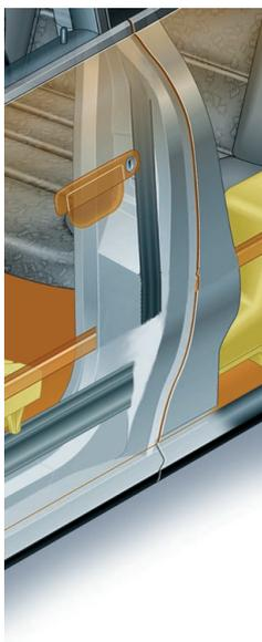
Breitflächige Überlappung der Tür an den Pfosten und im Schwellerbereich
