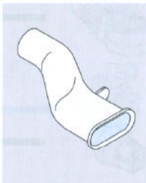
Der verringerte Querschnitt der Ansaugmündung vermindert die Ansaugeräusche.
