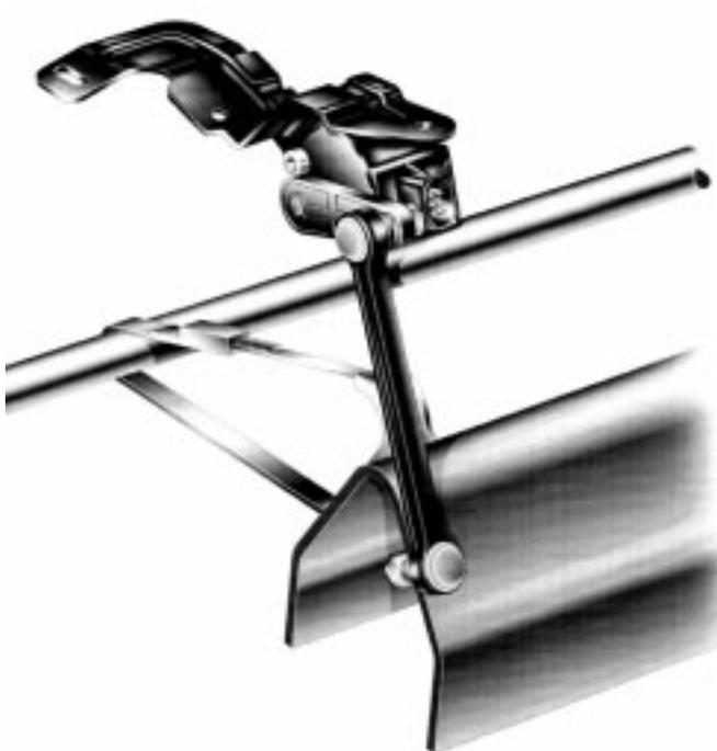
Bei Fahrzeugen mit Verbundlenker-Hinterachse ist der Drehwinkelsensor am stehendem Achsprofil der Verbundlenkerachse und an der Karosserie befestigt. Es wird der Abstand zwischen Karosserie und Achse gemessen.
