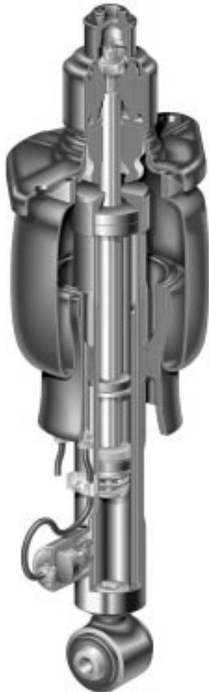
Bei Fahrzeugen mit Doppelquerlenker-Hinterachse sind die Luftfedern im Federbein integriert.
