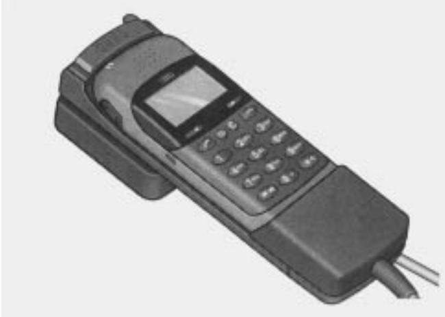
Das Audi Handy (Hersteller AEG) ist eines der kleinen, leichten und leistungsstarken Geräte, die Mobilkommunikation so attraktiv machen. Es wiegt nur 255 Gramm, die Akkus leisten 44 Stunden Stand-By-Betrieb oder 160 Minuten Gesprächszeit. Der Betrieb erfolgt mit einer leicht auswechselbaren großen Telefonkarte.
