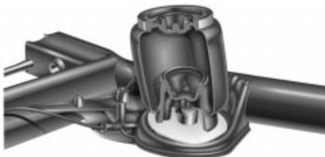
Die Luftfedern sind zweilagige Schlauchrollbälge ohne äußere Führung.
