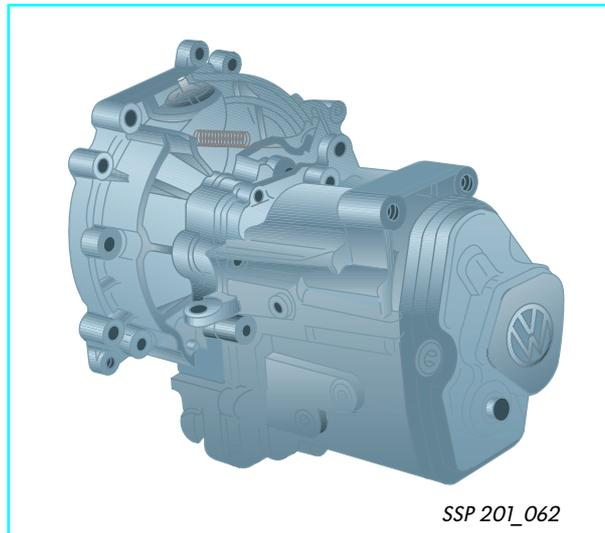
L'harmonisation de l'ensemble des démultiplications de la boîte en fonction de la version du moteur montée est obtenue par des démultiplications des vitesses différentes et des démultiplications différentes des transmissions. L'appariement de la boîte au moteur s'effectue en fonction des lettres-repères.
