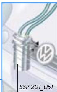
Le réservoir à charbon actif est situé à l'avant à droite dans le véhicule. Le charbon actif emmagasine les particules de carburant contenues dans les vapeurs de carburant.
