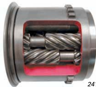
Différentiel interpont PAT (Parallel Axis Torsen)
