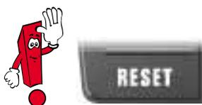
En appuyant sur la touche Reset du menu de commande principal, la température de 22 °C ainsi que la vitesse de rotation de la soufflante réglées en usine sont à nouveau sélectionnées. La répartition de l'air est réglée sur „Auto“ et le recyclage d'air est désactivé.
