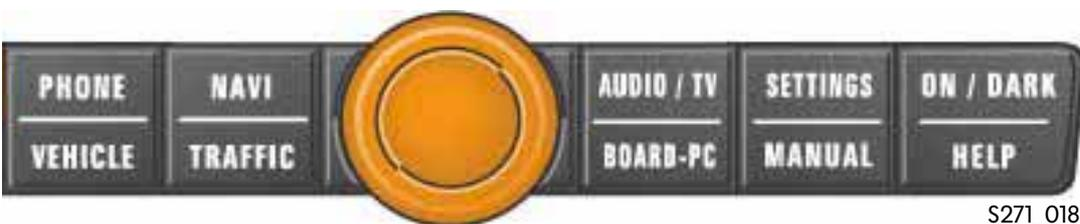
Bouton rotatif/bouton-poussoir pour le réglage de la vitesse de soufflante dans le menu principal du climatiseur
