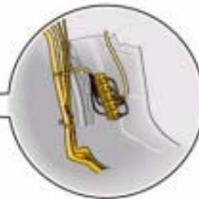
Boîtier des thermofusibles à l'avant, à gauche au plancher
