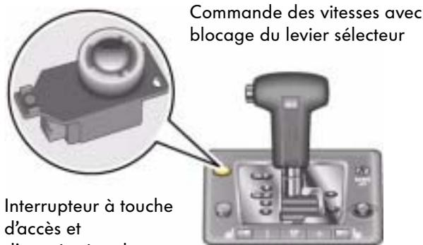
Commande des vitesses avec blocage du levier sélecteur
