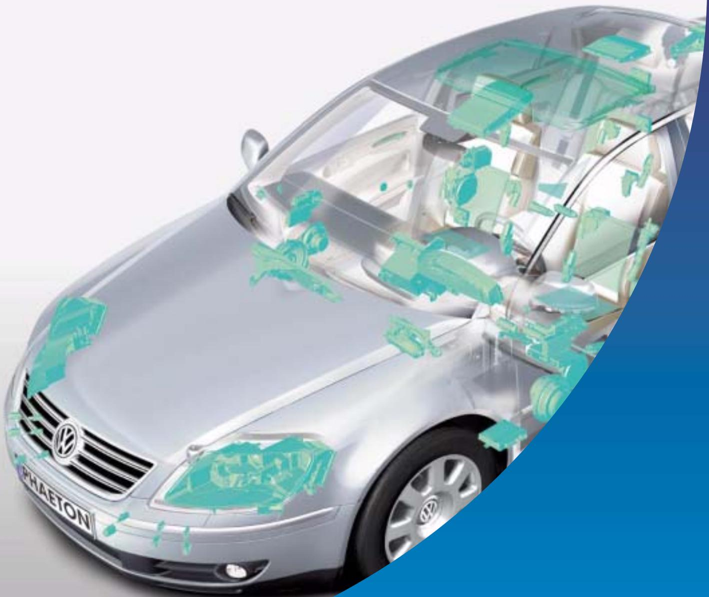
Sésame ouvre-toi ! Un nouveau système d'accès et d'autorisation de démarrer permet d'accéder à la Phaéon sans utiliser activement la clé du véhicule (1). Une antenne intégrée à la poignée extérieure de porte (2) détecte le souhait d'ouverture du véhicule et un appareil de commande (3) en identifie l'autorisation : le déverrouillage intervient alors sous l'impulsion de l'appareil de commande central du système confort (4) et de l'appareil de commande de porte (5).
