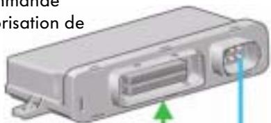
Verrouillage électromécanique de colonne de direction
