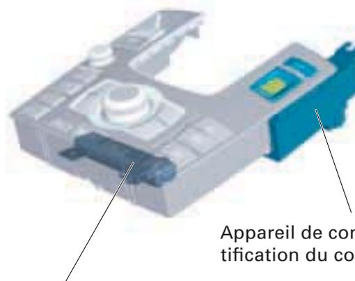
Appareil de commande d'identification du conducteur J589
