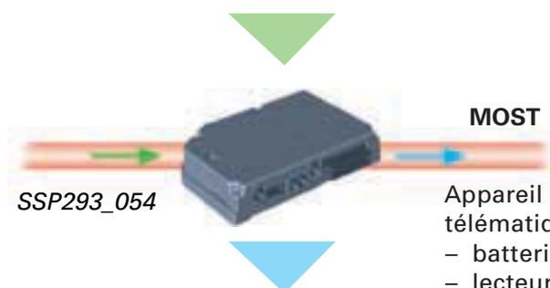
Appareil de commande de téléphone/télématique J526 avec
