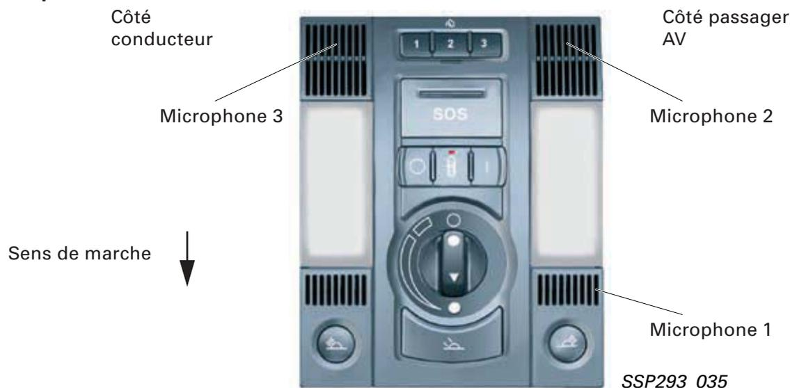
L'équipement de pointe de l'Audi A8 '03 comporte trois microphones regroupés dans une unité dans le module de toit avant.
