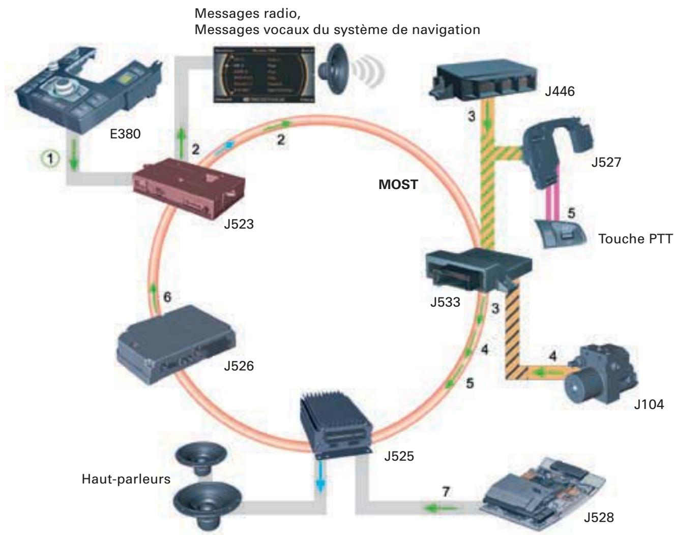
La transmission des signaux audio s'effectue, à partir de toutes les sources audio, directement à l'aide du bus MOST vers l'appareil de commande de processeur d'ambiance sonore DSP J525.
