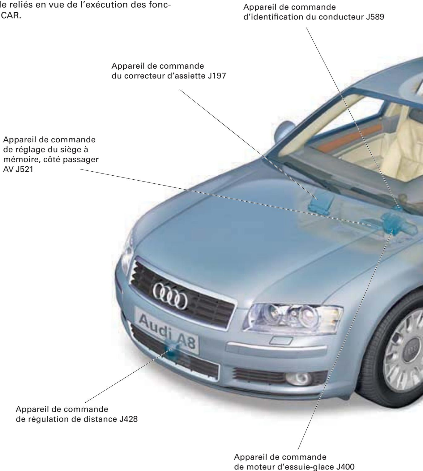
Appareil de commande d'identification du conducteur J589
