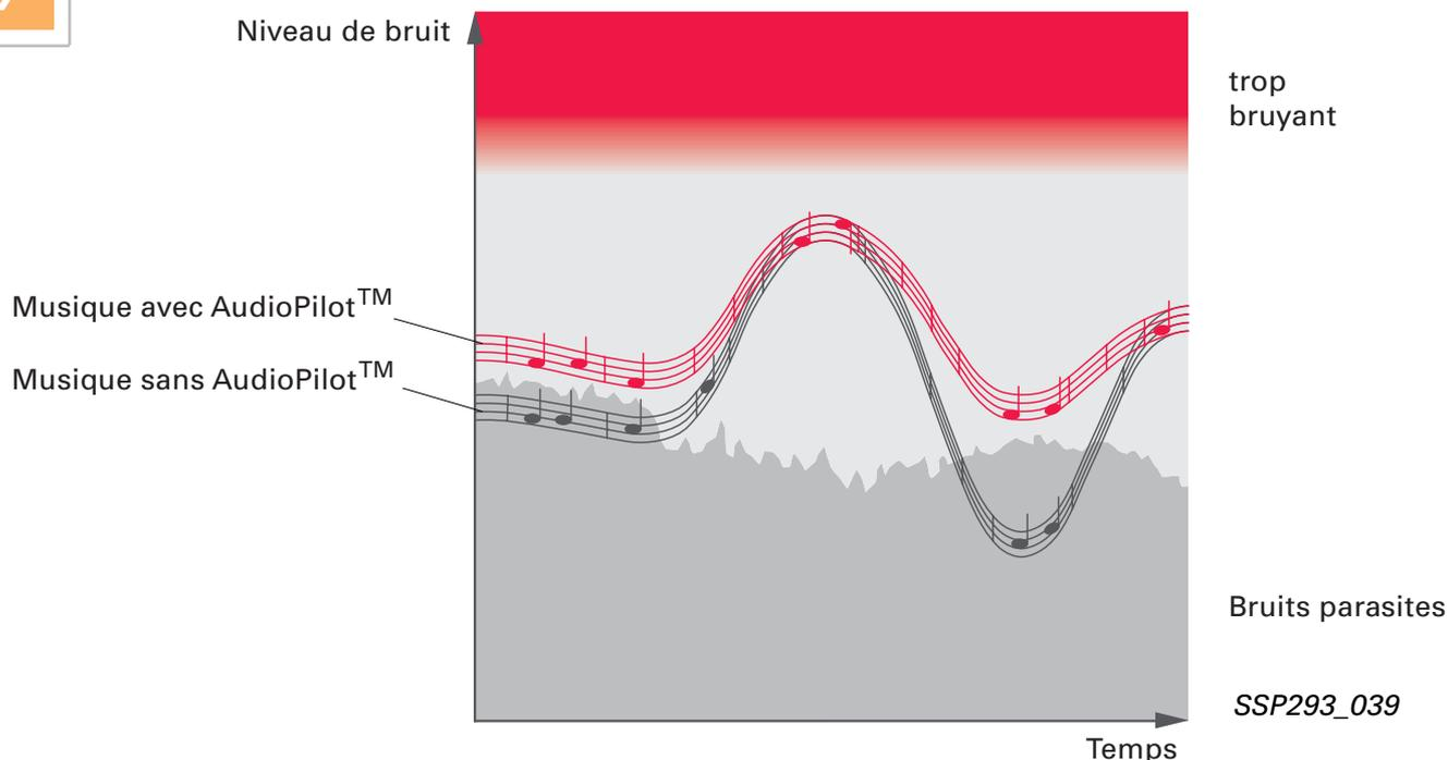
Les bruits parasites sont enregistrés par les microphones du module de toit et analysés par l'appareil de commande de processeur d'ambiance sonore DSP J525.
