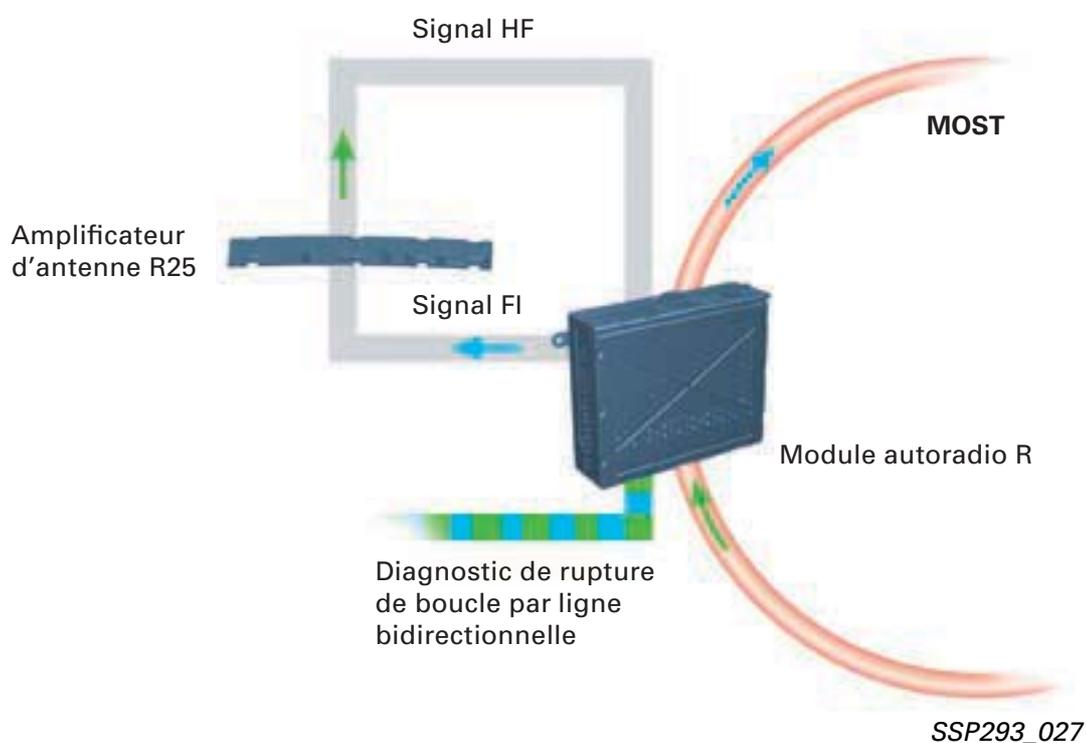
La réception des stations radio s'effectue à l'aide de quatre antennes FM et d'une antenne AM intégrées dans la glace AR.
