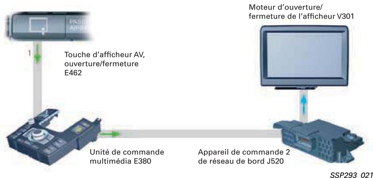
La fermeture de l'afficheur par actionnement de la touche d'ouverture/fermeture E462 est exclusivement réalisée par la transmission de données à l'aide des réseaux en bus.
